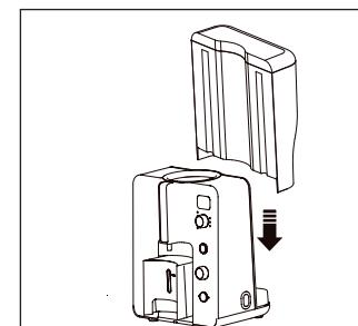
La machine à thé est équipée d'une surveillance du remplissage du réservoir. La limite minimum (MIN) est fixée environ à 700 ml au-dessus de laquelle toute préparation unitaire de tasse lancée peut être finalisée.
